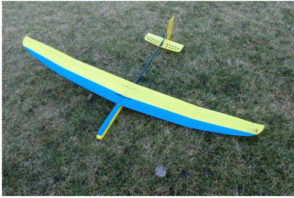
Hier der neue Sling KIS, hier werden alle drei Achsen mittels Ruder bedient
