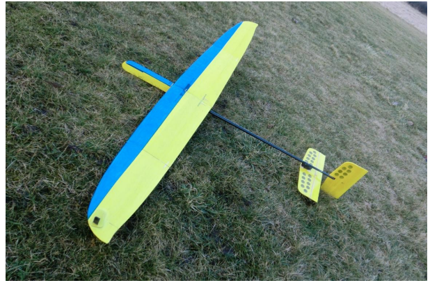
Hier der neue Sling KIS, hier werden alle drei Achsen mittels Ruder bedient
