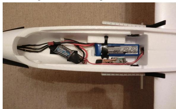
Flächensteckung mit CFK- Rohr und Ansicht Regler und Antriebsakkus.
